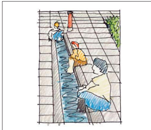
Figura 3.3. Runnels (canales para correr). Canales abiertos de agua que están diseñados como equipamiento urbano. Pueden ser usados para conducir agua limpia de lluvia hasta los cancheros o a otros dispositivos de conducción pluvial.
