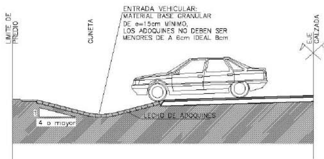
1.1— INTERFERENCIA ENTRE CUNETA ANCHA CON TALUD MAYOR A 4:1 Y ENTRADA DE GARAGE. EN ESTE CASO SE COLOCA UN LECHO DE ADOQUINES SOBRE LA CUNETA QUE PERMITE EL PASAJE DEL VEHÍCULO.
