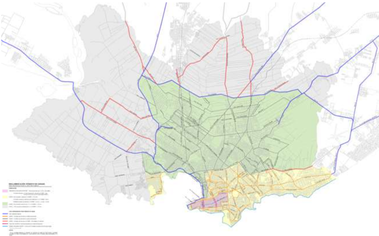
↑ Montevideo, Uruguay. Restricciones de circulación al transporte de carga por tipos de vehículos y por horarios en zonas y subzonas de exclusión dentro del Anillo Perimetral Vial de Montevideo. Imagen: https://montevideo.gub.uy/areas-tematicas/movilidad/transporte-de-carga/transporte-de-carga
